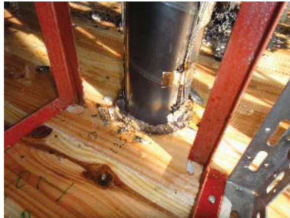
写真 3.6.4-7 試験体 A 仕様①試験後非加熱面
