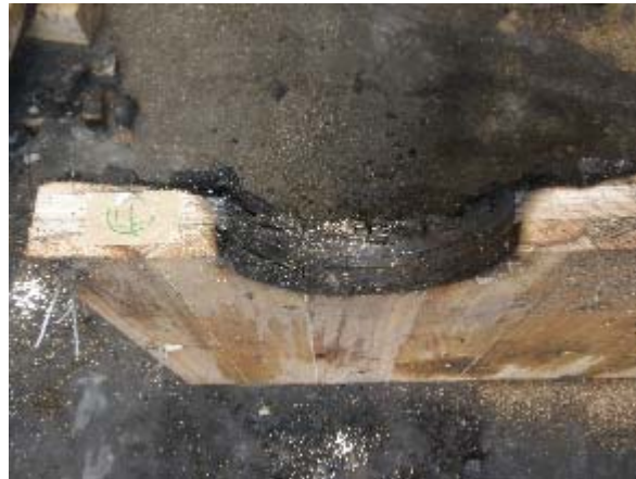
写真 3.6.4-41 試験体 B 仕様④試験後の CLT 断面
