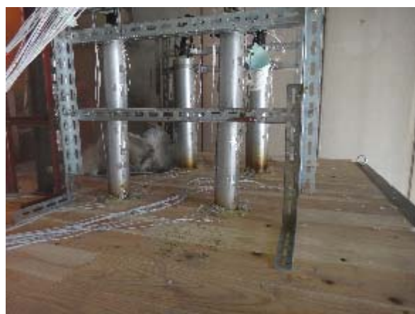
写真 3.6.4-5 試験体 A 加熱 90 分後非加熱面
