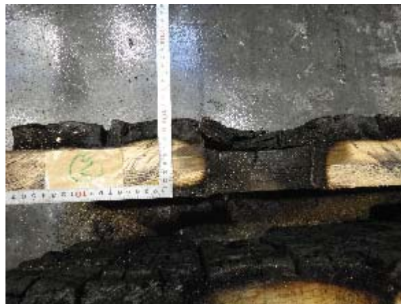
写真 3.6.4-11 試験体 A 仕様②試験後の CLT 断面
