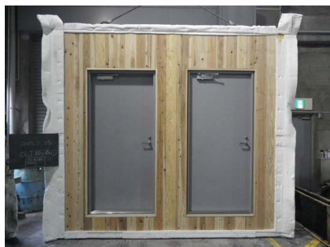
写真 3.5-1 CLT 防火設備(加熱前)
