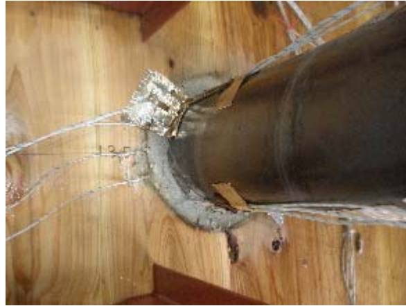
写真 3.6.4-31 試験体 B 仕様①試験後非加熱面
