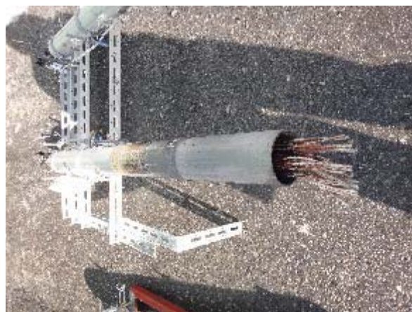
写真 3.6.4-21 試験体 A 仕様⑤試験後の貫通管
