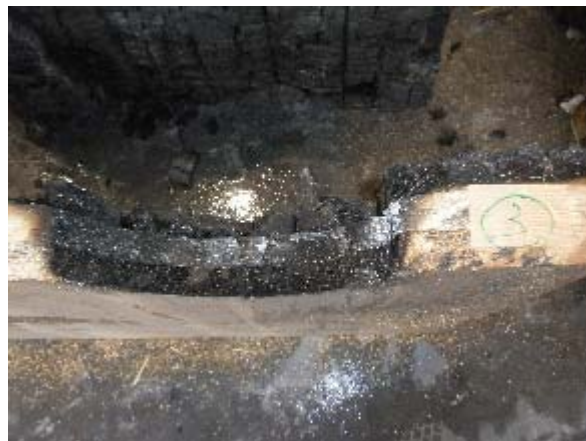
写真 3.6.4-38 試験体 B 仕様③試験後の CLT 断面
