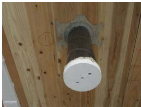
写真 3. 6. 2-27 試験体 B 仕様① 加熱側拡大
