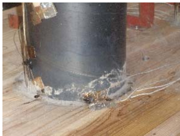
写真 3.6.4-26 試験体 B 加熱 60 分後非加熱面
