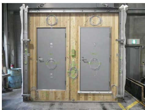
写真 3.5-2 CLT 防火設備(加熱前)
