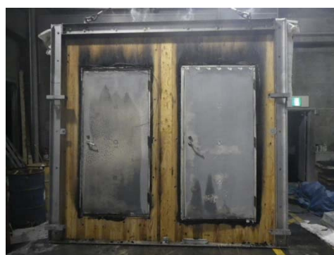
写真 3.5-4 CLT 防火設備試験体(加熱後)
