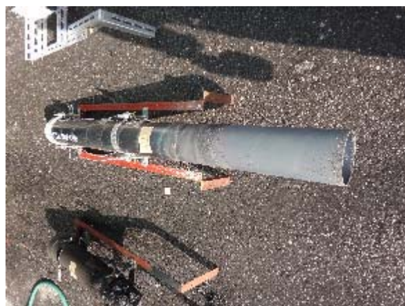
写真 3.6.4-9 試験体 A 仕様①試験後の貫通管
