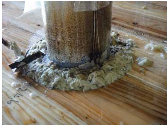
写真 3.6.4-22 試験体 A 仕様⑥試験後非加熱面
