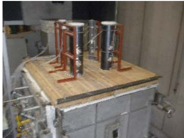
写真 3.6.4-25 試験体 B 加熱開始前の非加熱面
