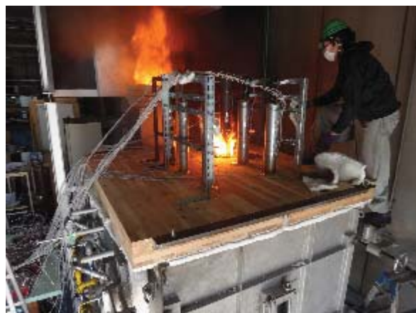
写真 3.6.4-4 試験体 A 加熱 81 分後の非加熱面 (仕様②を消火)
