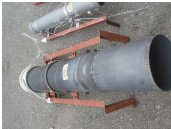
写真 3.6.4-42 試験体 B 仕様④試験後の貫通管
