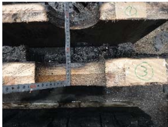
写真 3.6.4-14 試験体 A 仕様③試験後の CLT 断面
