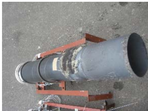
写真 3.6.4-39 試験体 B 仕様③試験後の貫通管
