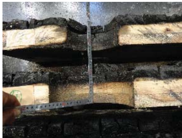
写真 3.6.4-17 試験体 A 仕様④試験後の CLT 断面
