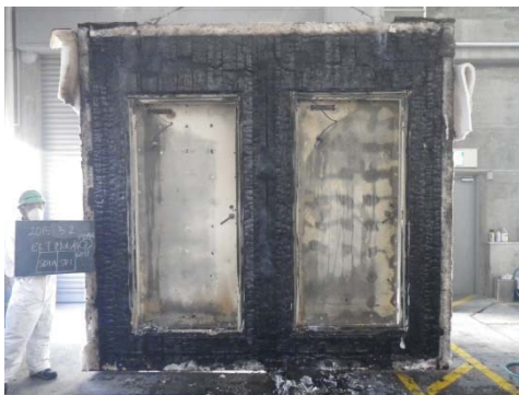
写真 3.5-19 CLT 防火設備(加熱後)
