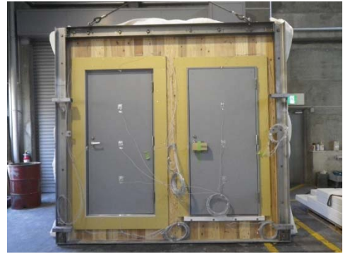
写真 3.5-18 CLT 防火設備(加熱前)
