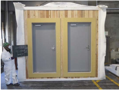
写真 3.5-17 CLT 防火設備(加熱前)
