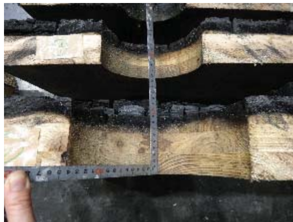
写真 3.6.4-23 試験体 A 仕様⑥試験後の CLT 断面
