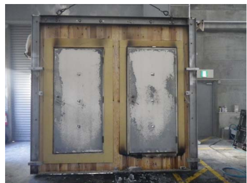
写真 3.5-20 CLT 防火設備試験体(加熱後)
