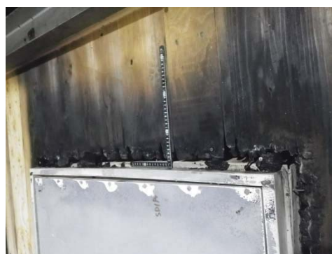
写真 3.5-6 試験体 SD1A(枠上部炭化範囲)
