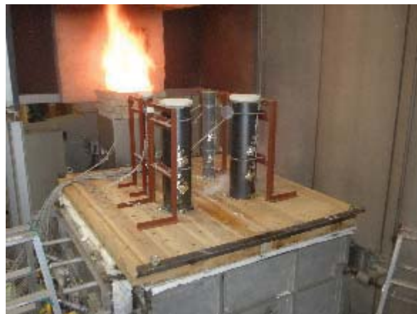
写真 3.6.4-26 試験体 B 加熱 60 分後非加熱面
