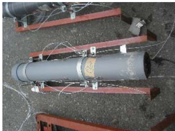
写真 3.6.4-36 試験体 B 仕様②試験後の貫通管
