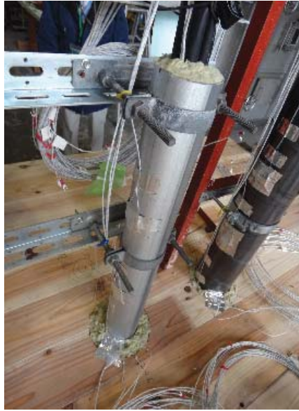
写真 3. 6. 2-10 試験体 A 仕様③ 非加熱側
