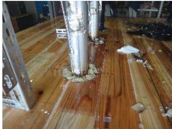
写真 3.6.4-19 試験体 A 仕様⑤試験後非加熱面
