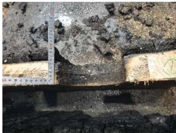
写真 3.6.4-8 試験体 A 仕様①試験後の CLT 断面
