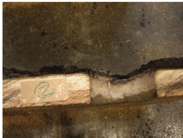
写真 3.6.4-35 試験体 B 仕様②試験後の CLT 断面
