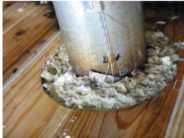
写真 3.6.4-16 試験体 A 仕様④試験後非加熱面
