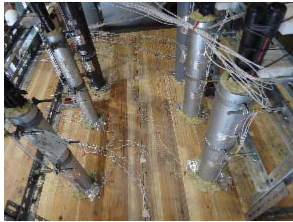
写真 3.6.4-1 試験体 A 加熱開始前の非加熱面
