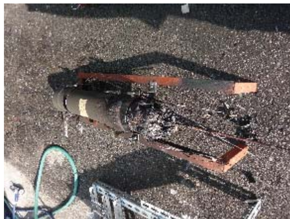
写真 3.6.4-12 試験体 A 仕様②試験後の貫通管
