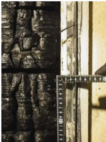
写真 3.5-11 試験体 SD1A(右壁枠取合部隙間)
