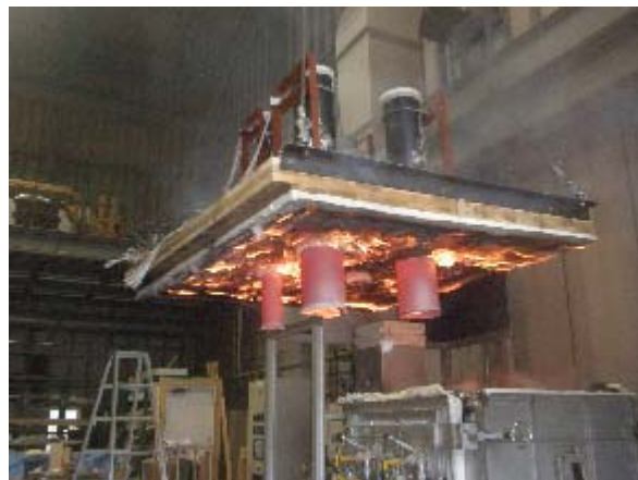
写真 3.6.4-29 試験体 B 脱炉直後の加熱面
