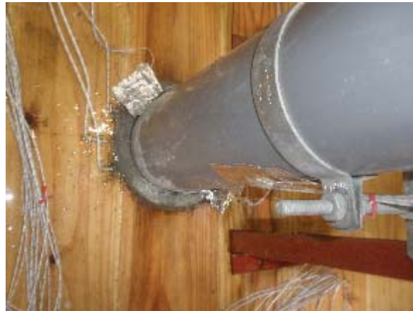
写真 3.6.4-34 試験体 B 仕様②試験後非加熱面
