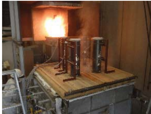
写真 3.6.4-28 試験体 B 加熱 90 分後非加熱面
