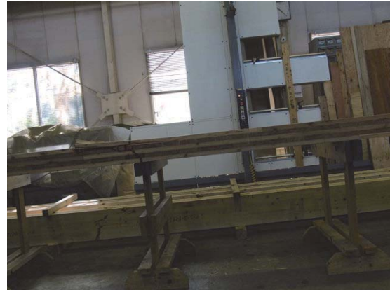
写真 8-3、8-4 外層スギ・内層スギの試験体の破壊の様子（幅方向と厚さ方向）
