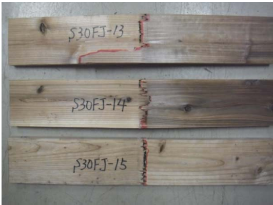
写真 2.9-3 M30FJ ラミナ破壊状況例
