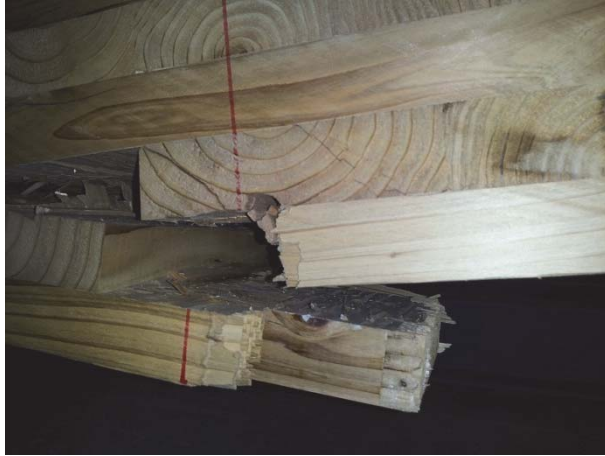
写真 2.3-7 荷重レベル 80%破壊 FJ 破壊状況詳細
