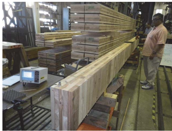
写真 8-1 T.G.H.法による固有振動数の測定の様子
