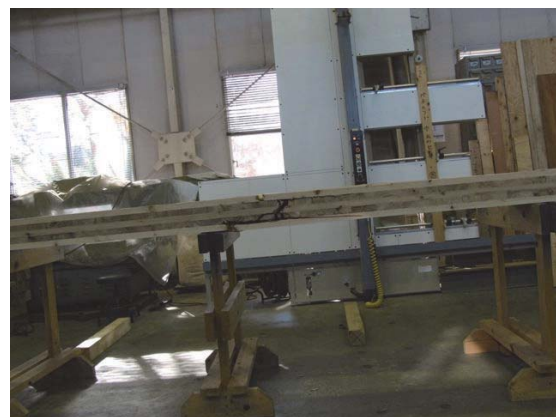
写真 8-5、8-6 外層ヒノキ・内層スギの試験体の破壊の様子（幅方向と厚さ方向）
