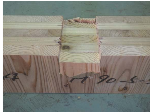
図 2.6-7 荷重変形曲線と破壊状況 (5層_弱軸_縦使い)
