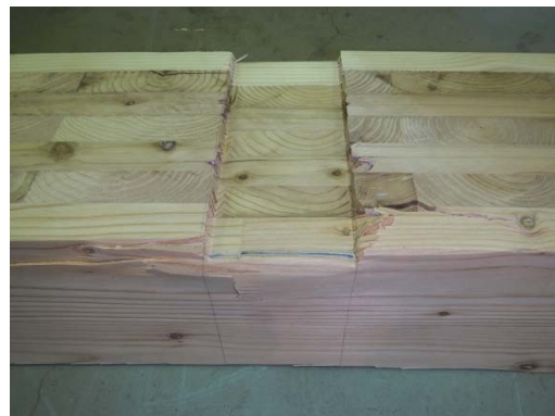
図 2.6-9 荷重変形曲線と破壊状況 (7層_強軸_縦使い)
