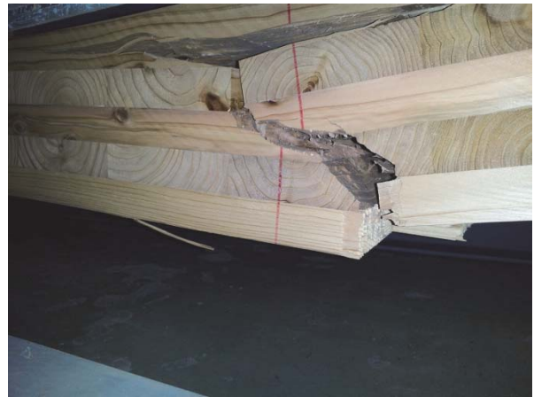
写真 2.3-5 強軸試験体破壊(左荷重レベル 90%) 写真 2.3-6 荷重レベル 90%FJ 破壊状況詳細
