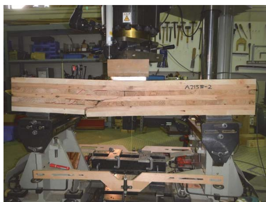
図 2.5-5 荷重-変位曲線と破壊後の様子 (7層強軸)
