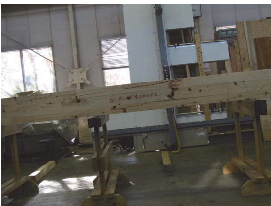
写真 8-5、8-6 外層ヒノキ・内層スギの試験体の破壊の様子（幅方向と厚さ方向）
