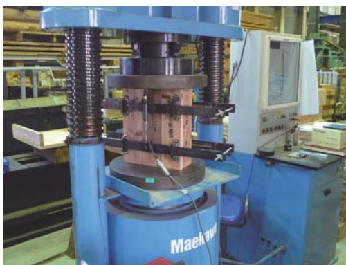
写真 2.7.1-1 圧縮試験の様子
