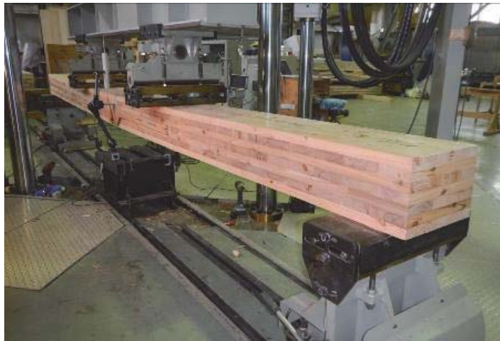
写真 2.2-1 面外曲げ試験の様子
