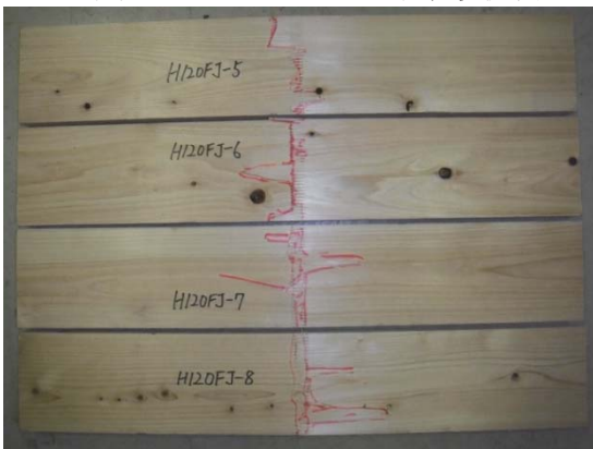
写真 2.9-9 M120FJ ラミナ破壊状況例
