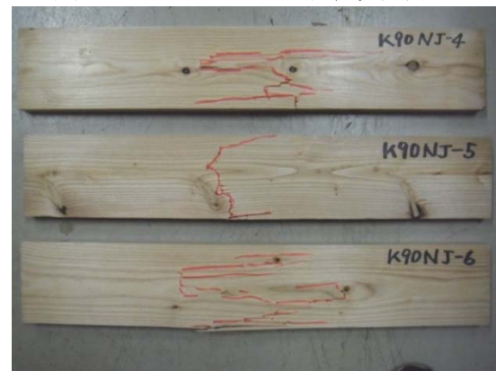
写真 2.9-8 M90NJ ラミナ破壊状況例
