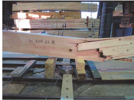
写真 2.4-3 外層ヒノキ・内層スギの試験体の破壊の様子の一例 (いずれも外層強軸方向)
