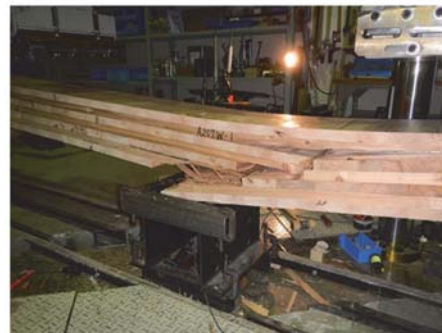
図 2.2-2 荷重－変位曲線と破壊形態の一例
