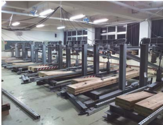
写真 2.3-1 モーメントアーム式試験機
