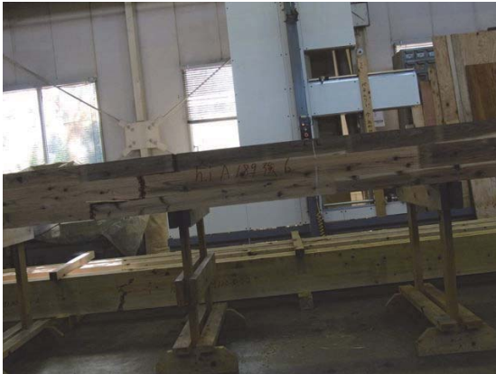
写真 8-3、8-4 外層スギ・内層スギの試験体の破壊の様子（幅方向と厚さ方向）
