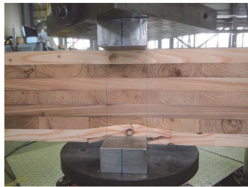
図 2.6-8 荷重変形曲線と破壊状況 (7層_強軸_平使い)
