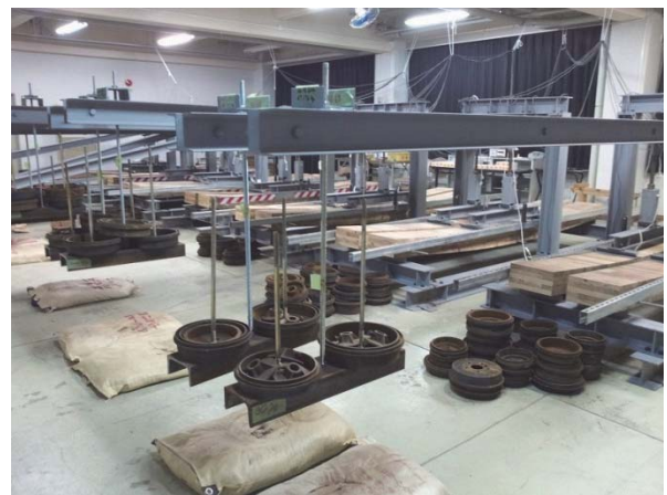
写真 2.3-4 弱軸試験体の錘の状況
