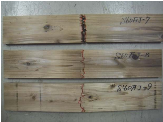
写真 2.9-5 M60FJ ラミナ破壊状況例
