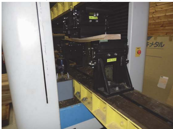
写真 2.9-1 ラミナ曲げ試験状況
