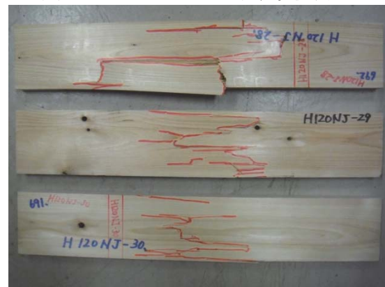
写真 2.9-10 M120NJ ラミナ破壊状況例
