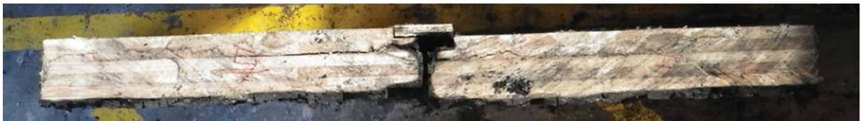
写真 3.3.4. (2)-5 CLT 載荷床②試験体(スギ・API 接着剤・30mm・7層・7ply) 219kN
