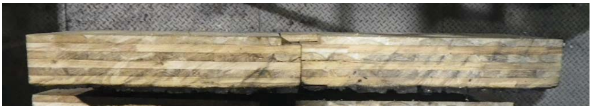
写真 3.3.4. (4)-5 CLT 荷床④試験体(スギ・API 接着剤・30mm・5層・7ply) 226kN
