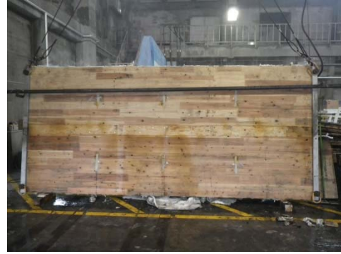
写真 3.3.4. (5)-4 CLT 載荷屋根⑤試験体 (加熱後)
