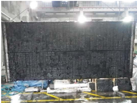
写真 3. 3. 4. (3)-3 CLT 載荷床③試験体 (加熱後)
