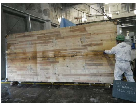
写真 3.3.4.(2)-4 CLT 載荷床②試験体 (加熱後)
