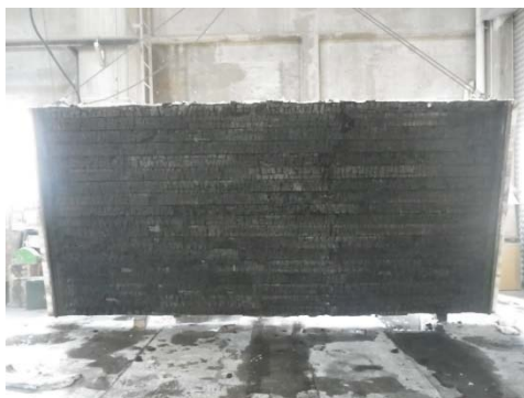
写真 3. 3. 4. (4)-3 CLT 載荷床④試験体 (加熱後)
