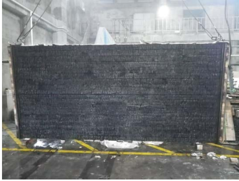
写真 3.3.4. (5)-3 CLT 載荷屋根⑤試験体 (加熱後)
