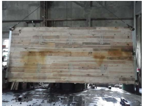
写真 3. 3. 4. (3)-4 CLT 載荷床③試験体 (加熱後)
