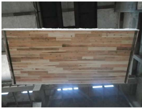
写真 3. 3. 4. (4)-1 CLT 載荷床④試験体 (加熱前)
