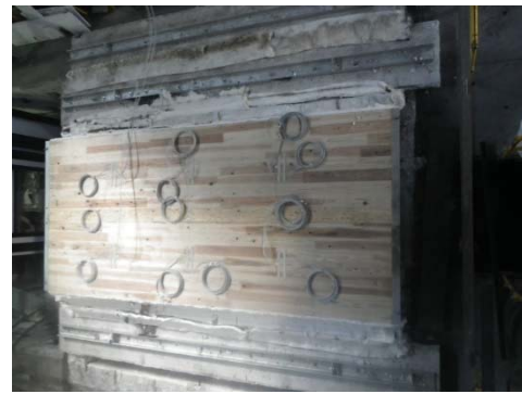
写真 3. 3. 4. (4)-2 CLT 載荷床④試験体 (加熱前)
