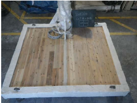
写真 3. 3. 4. (6)-1 CLT 床上試験体 (加熱前)
