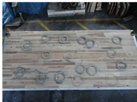
写真 3.3.4.(2)-2 CLT 載荷床②試験体 (加熱前)
