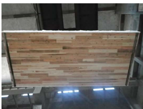
写真 3.3.4. (5)-1 CLT 載荷屋根⑤試験体 (加熱前)
