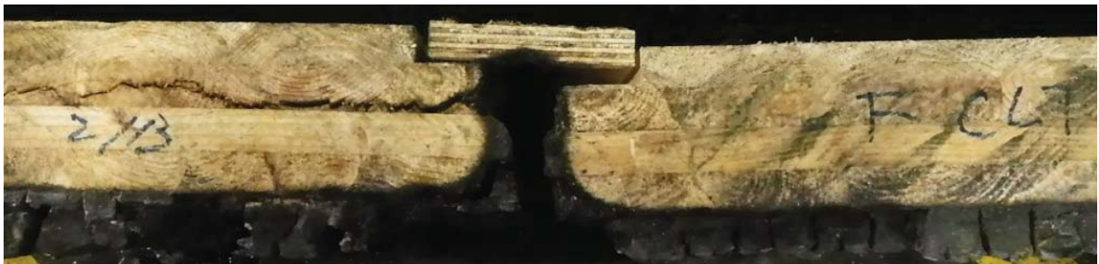
写真 3.3.4. (3)-5 CLT 荷床③試験体(スギ・API 接着剤・30mm・5層・7ply) 141kN
