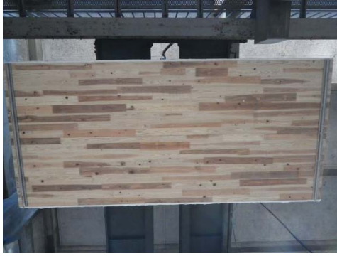
写真 3. 3. 4. (3)-1 CLT 載荷床③試験体 (加熱前)
