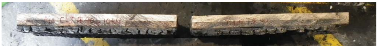
写真 3.3.4.(5)-5 CLT 荷重屋根⑤試験体(スギ・API 接着剤・30mm・3層・3ply) 10kN
