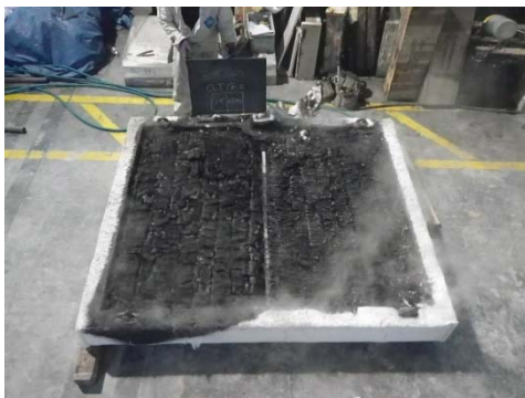
写真 3. 3. 4. (6)-3 CLT 床上試験体 (加熱後)
