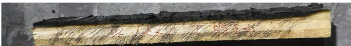
写真 3. 3. 4. (6)-7 CLT 床上試験体 C 断面(カラマツ・API 接着剤・30mm・7 層・7ply)
