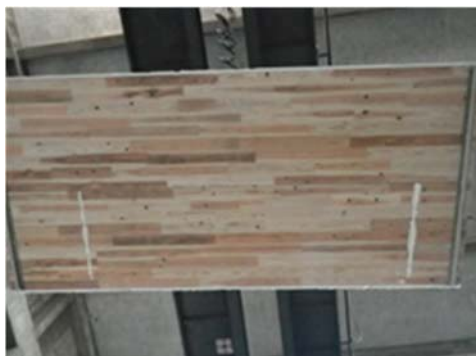
写真 3.3.4.(2)-1 CLT 載荷床②試験体 (加熱前)
