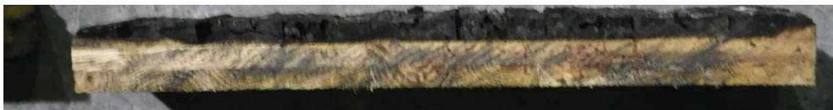
写真 3. 3. 4. (6)-5 CLT 床上試験体 A 断面(スギ・API 接着剤・30mm・7 層・7ply)
