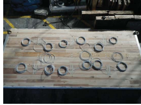
写真 3. 3. 4. (3)-2 CLT 載荷床③試験体 (加熱前)
