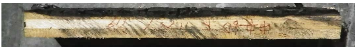
写真 3. 3. 4. (6)-8 CLT 床上試験体 D 断面(カラマツ・API 接着剤・30mm・7 層・7ply)
