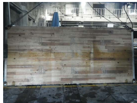
写真 3. 3. 4. (4)-4 CLT 載荷床④試験体 (加熱後)
