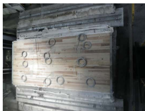
写真 3.3.4. (5)-2 CLT 載荷屋根⑤試験体 (加熱前)
