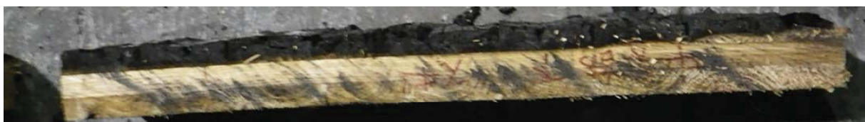
写真 3. 3. 4. (6)-6 CLT 床上試験体 B 断面(スギ・API 接着剤・30mm・7 層・7ply)
