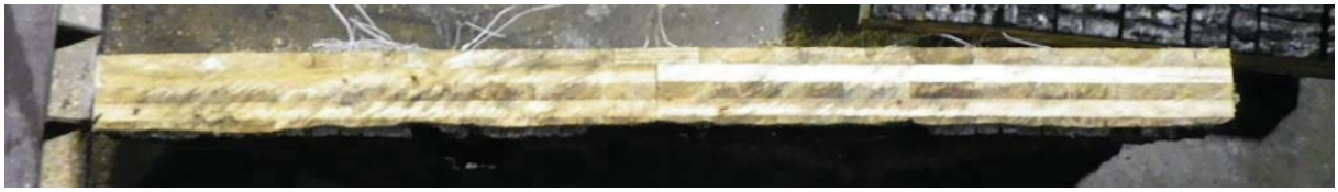
写真 3.3.4. (1)-5 CLT 載荷床①試験体(スギ・API 接着剤・30mm・7層・7ply) 151kN
