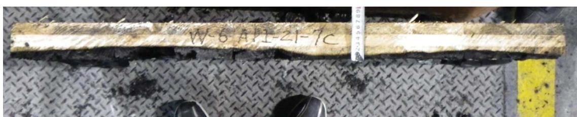
写真 3.1.4. (1)-10 W-6(API接着剤・ラミナ厚 21mm・7層) パネル厚 147mm
