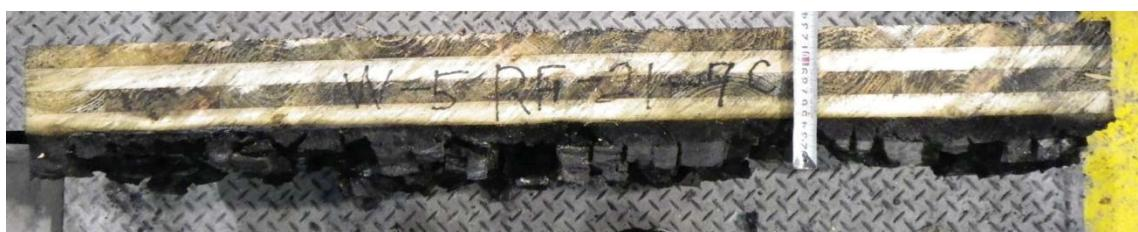
写真 3.1.4. (1)-9 W-5(RF接着剤・ラミナ厚 21mm・7層) パネル厚 147mm
