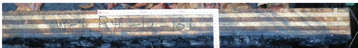
写真 3.1.4. (2)-5 W-1 カラマツ (RF・ラミナ厚 12mm・13 層) パネル厚 156mm
