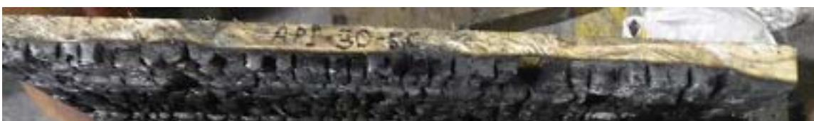
写真 3.1.4. (3)-6 W-2 スギ(API接着剤・ラミナ厚 30mm・5層) パネル厚 150mm
