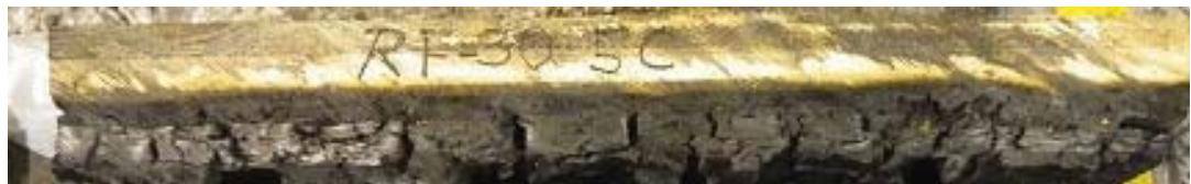
写真 3.1.4. (3)-5 W-1 スギ(RF・ラミナ厚 30mm・5層) パネル厚 150mm
