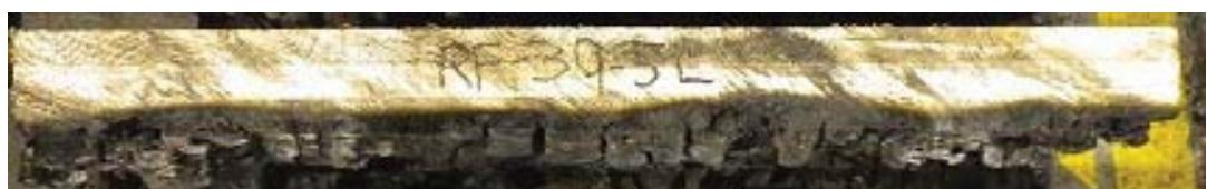
写真 3.1.4. (3)-7 W-3 カラマツ(RF接着剤・ラミナ厚 30mm・5層) パネル厚 150mm
