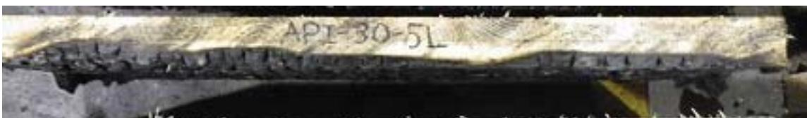
写真 3.1.4. (3)-8 W-4 カラマツ(API接着剤・ラミナ厚 30mm・5層) パネル厚 150mm
