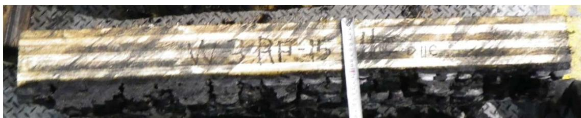
写真 3.1.4. (1)-7 W-3(RF接着剤・ラミナ厚 15mm・11層) パネル厚 165mm
