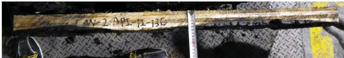
写真 3.1.4. (1)-6 W-2(API接着剤・ラミナ厚 12mm・13層) パネル厚 156mm
