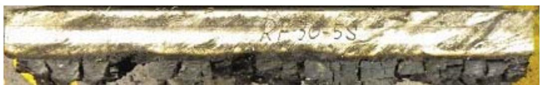
写真 3.1.4. (3)-9 W-5 スプルース(RF接着剤・ラミナ厚 30mm・5層) パネル厚 150mm
