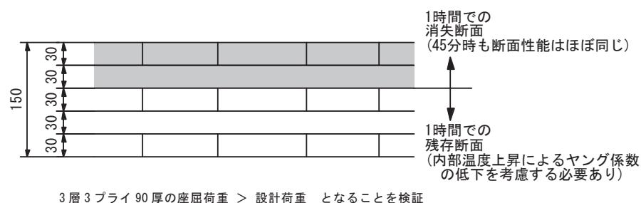
図 1.2-6 CLT パネルを用いた壁・床の燃えしろ設計の考え方の一例
