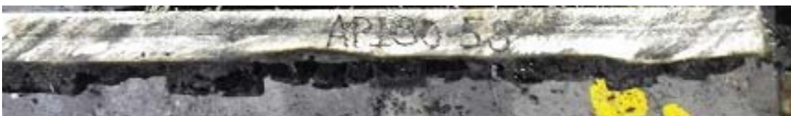
写真 3.1.4. (3)-10 W-6 スプルース(API接着剤・ラミナ厚 30mm・5層) パネル厚 150mm
