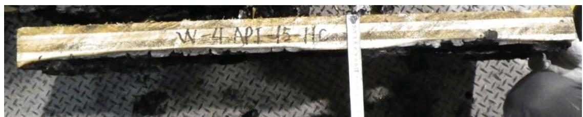
写真 3.1.4. (1)-8 W-4(API接着剤・ラミナ厚 15mm・11層) パネル厚 165mm
