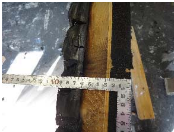
写真 3. 4. 2. 4-5 試験体 A 加熱後の仕様①エプトシーラー
