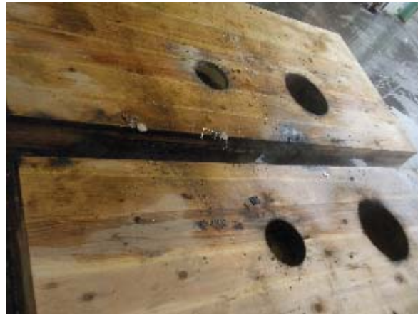
写真 3. 4. 2. 4-16 試験体 B 加熱後の目地突合せ面
