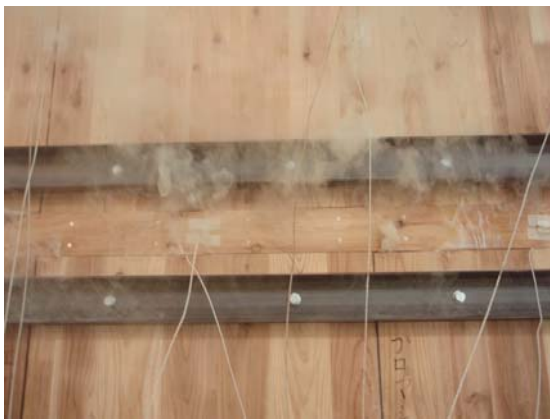
写真 3.4.1.4-3 合板目地部の煙噴出
