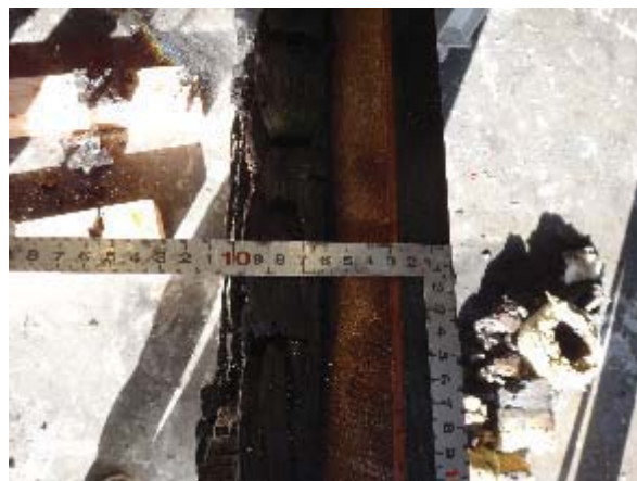
写真 3. 4. 2. 4-6 試験体 A 加熱後の仕様②プロマシール
