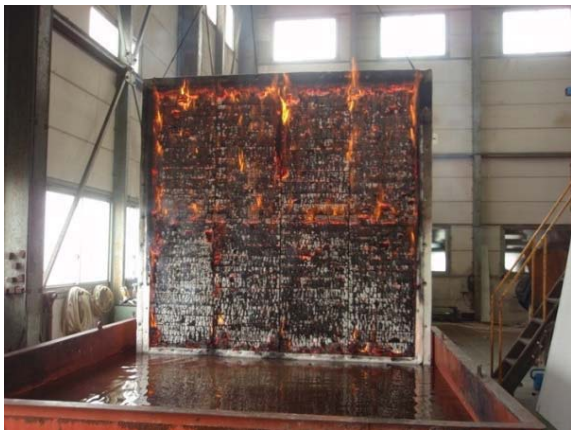
写真 3.4.1.4-11 試験終了後 試験体断面
