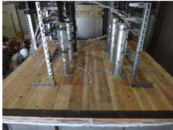
写真 3. 4. 2. 2-1 試験体 A 非加熱側全景 (奥が仕様①エプトシーラー、手前が仕様②プロマシール)
