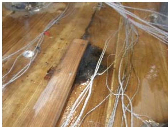
写真 3. 4. 2. 4-15 試験体 B 加熱後の仕様②炭化部拡大
