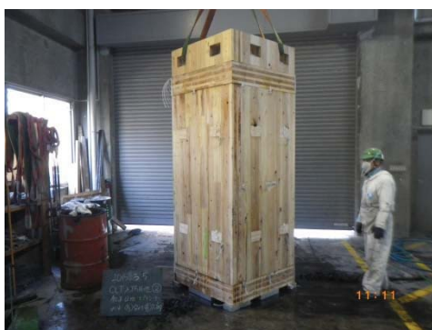
写真 3. 4. 3. 4. (2)-4 CLT 接合部②試験体（加熱後）
