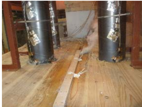
写真 3. 4. 2. 4-10 試験体 B 加熱 60 後の非加熱面
