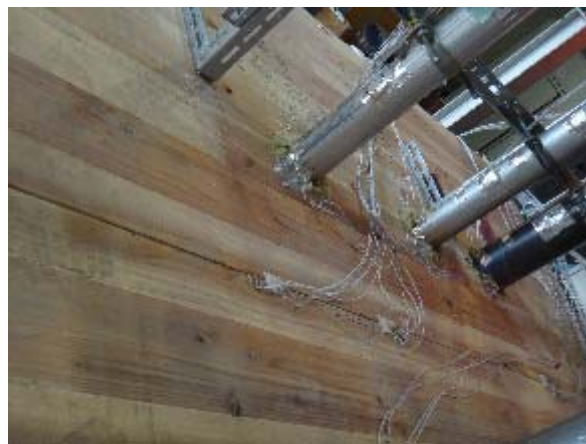
写真 3. 4. 2. 4-2 試験体 A 加熱 60 分後非加熱側
