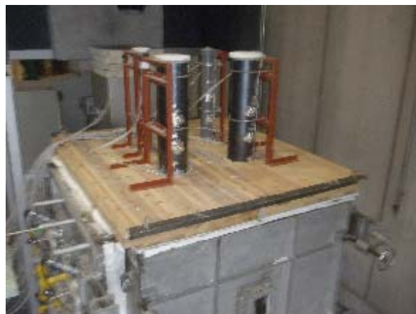
写真 3.4.2.4-9 試験体 B 加熱前の非加熱側
