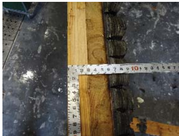
写真 3.4.2.4-8 試験体 A 加熱後の目地突合せ面（目地材非施工面）拡大
