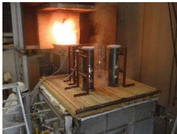
写真 3. 4. 2. 4-12 試験体 B 加熱 90 分後の非加熱面
