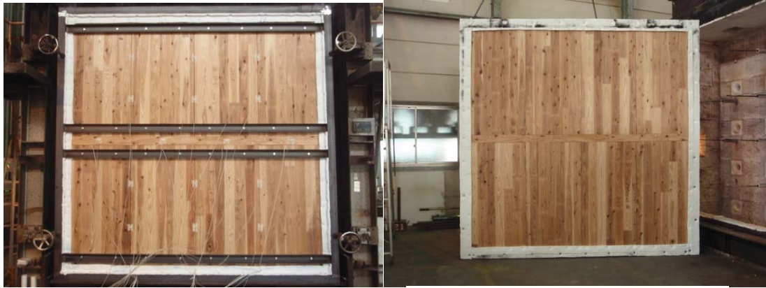
写真 3.4.1.4-1 試験前（加熱面）
