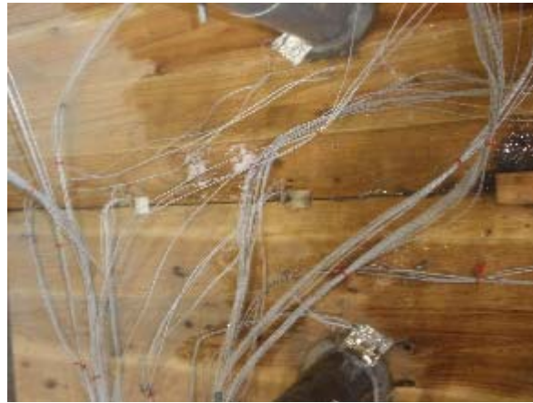
写真 3. 4. 2. 4-13 試験体 B 加熱後の仕様①非加熱面
