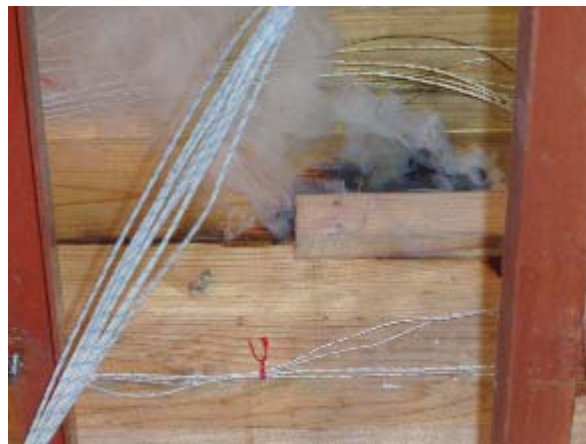
写真 3. 4. 2. 4-11 試験体 B 加熱 79 分後の目地非加熱面
