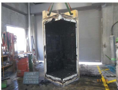
写真 3. 4. 3. 4. (2)-3 CLT 接合部②試験体（加熱後）
