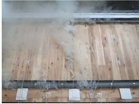
写真 3.4.1.4-8 縦目地からの煙噴出
