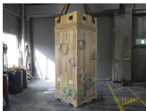
写真 3. 4. 3. 4. (2)-2 CLT 接合部②試験体（加熱前）
