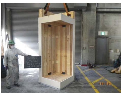
写真 3. 4. 3. 4. (2)-1 CLT 接合部②試験体（加熱前）
