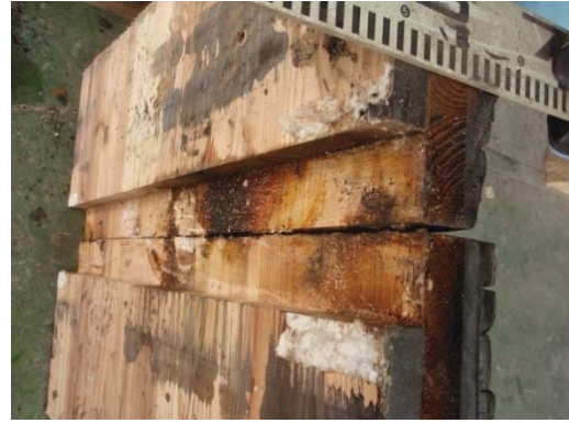
写真 3.4.1.4-14 スギ合板裏面側(試験後)
