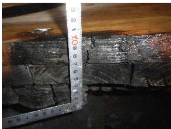
写真 3. 4. 2. 4-18 試験 B 加熱後の仕様②あて木炭化部
