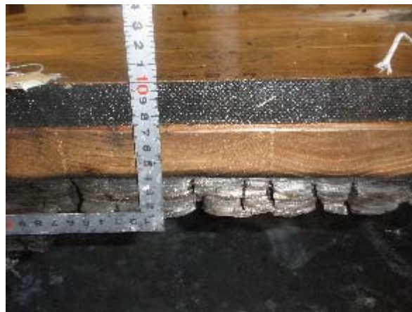
写真 3. 4. 2. 4-17 試験 B 加熱後の仕様①フィブロック
