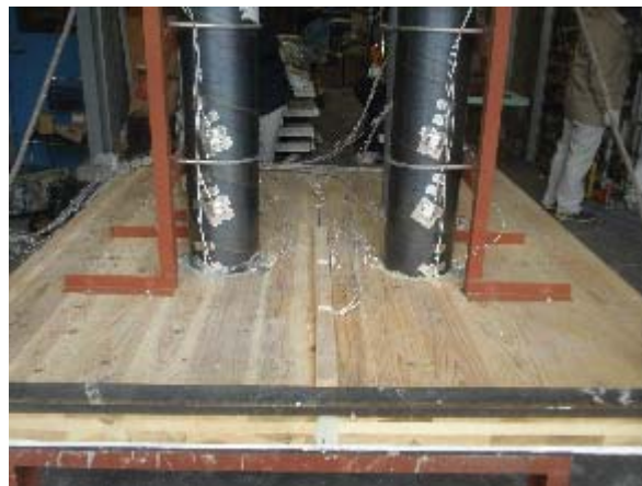
写真 3.4.2.2-5 試験体 B 非加熱側全景 (奥が仕様①ファイブロック、手前が仕様②あて木)
