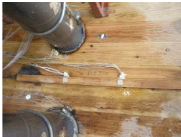
写真 3. 4. 2. 4-14 試験体 B 加熱後の仕様②非加熱面
