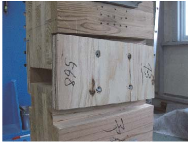
写真 2-3-2-5 FWT-L85 ビス頭のめり込み ビスの変形、引き抜け
