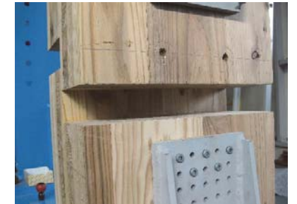
写真 2-3-2-8 FST-L290 ビス頭めり込み その他、ビスの変形、CLT 材相互の離間
