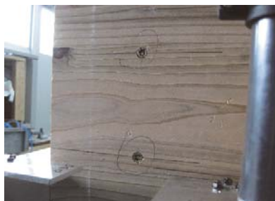
写真 2-3-2-13 TWS-L290 ビス頭のめり込み ビスの変形、引き抜け
