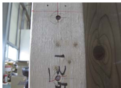
写真 2-3-2-12 TSS-N90d くぎの変形
