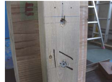
写真 2-3-2-9 TWS-L85 ビス頭めり込み ビスの変形
