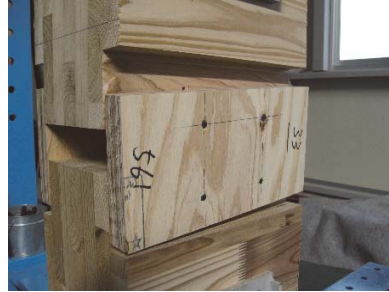
写真 2-3-2-6 FWT-N75 くぎ頭のめり込み くぎの変形、引き抜け
