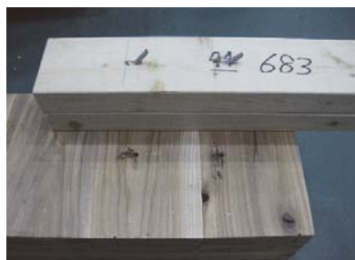
写真 2-3-2-15 TWS-L135 ビス頭のめり込み ビスの変形、折損、引き抜け
