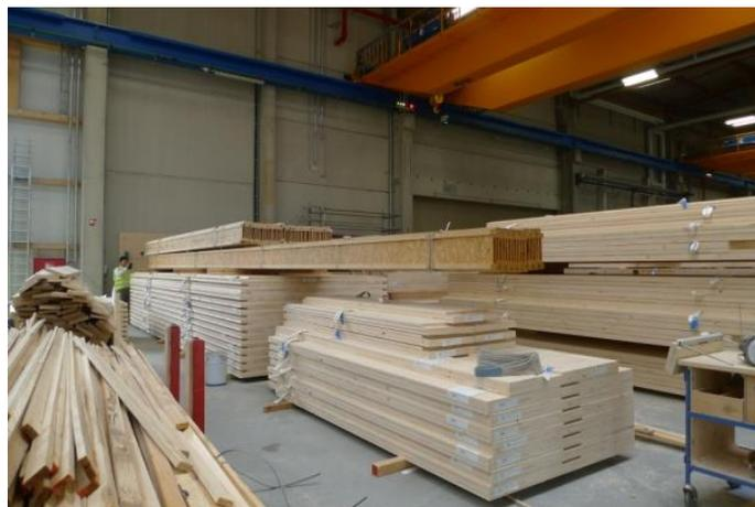
○製造しているCLTは、PURBOND社のポリウレタン接着剤を使用し、1回のプレスは4時間である。
