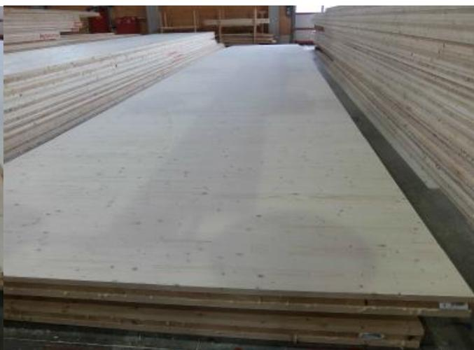
製造後のCLT(製造後の製品のみ写真撮影OK) 写真左が表面品質「Industrial(構造用)」グレード、写真右が「Visual(表し)」グレード
