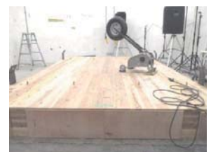
床版遮音性能測定試験
