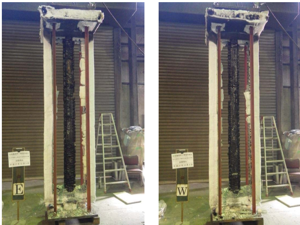
写真 4. 2. 4-1 脱炉後の様子
