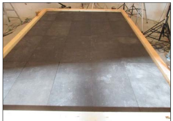
(6) 制振マット(2層目)の割付(試験体No.2-3)
