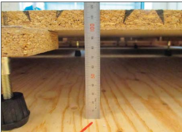
(3) 乾式二重床中央部の断面(試験体No.2-1~2-3)
