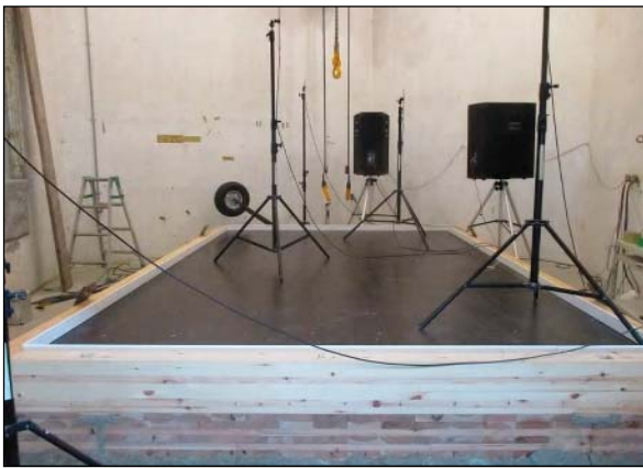
(3) 音響透過損失(音源側)
