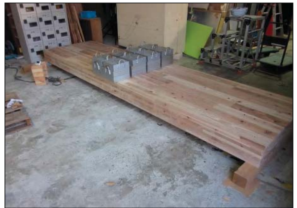
(6) 静的载荷によるたわみ量測定
