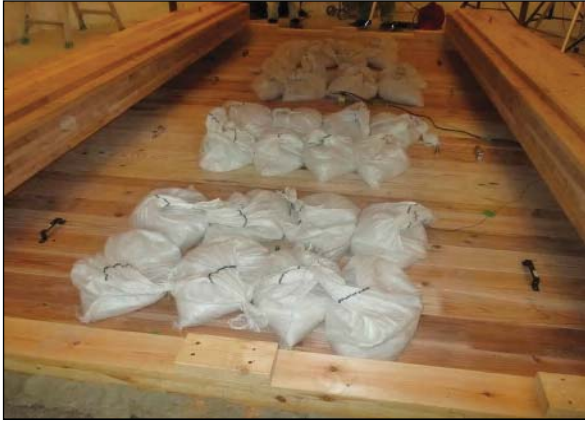
(1) 制振用砂袋の設置状況(試験体No.1-5)
