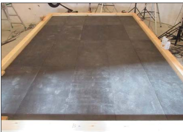
(5) 制振マットの割付(試験体No.2-2,2-3)
