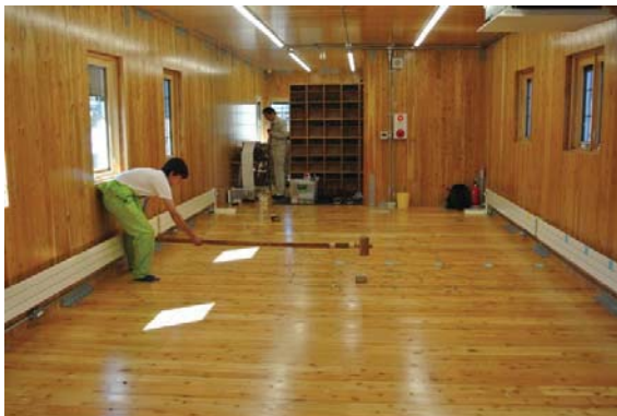
写真 3.1 CLT セミナーハウス 歩行振動測定の様子
