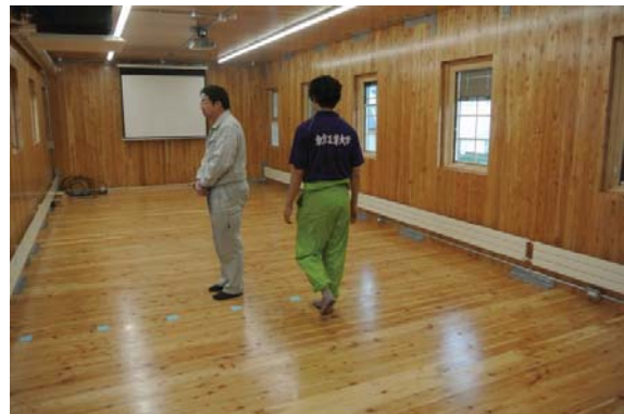
写真 3.1 CLT セミナーハウス 歩行振動測定の様子
