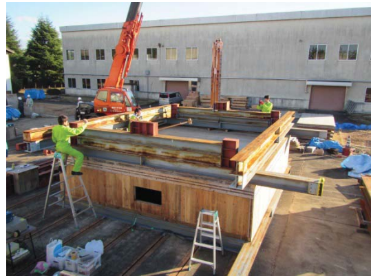
図 3.51 森林総研+ \alpha モデル：K点加振
