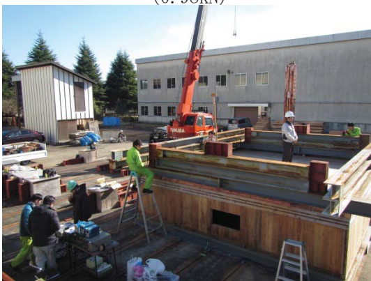
図 3.44 勝どき+ \alpha モデル：J 点に 1 人乗って K 点加振
