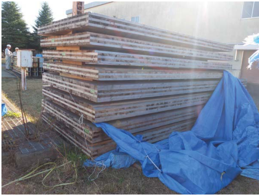
図 3.16 CLT 床板 (5.5m×4m、5層7プライ)
