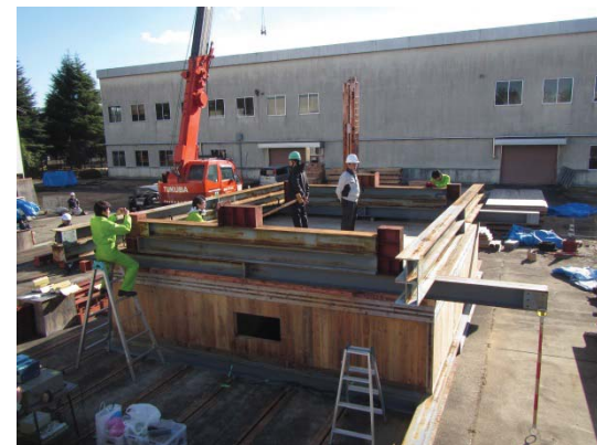
図 3.45 勝どき+ \alpha モデル：J 点に 1 人、J' 点にもう 1 人乗って K 点加振
