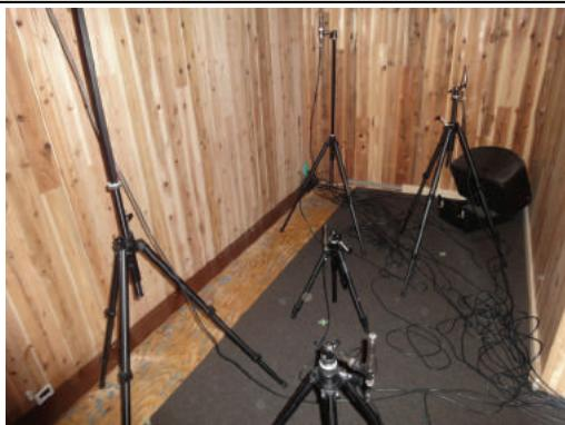
「①廊下側室」の機材設置状況。右角に音源1のスピーカーを角に向けて設置。集音マイク5ヶ所をサイコロの「5の目型」に配置。画面左下に温室度測定機を設置。
