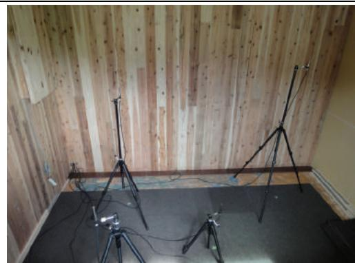
「②窓側室」の機材設置状況。音源2のスピーカーは左下の角(画面の外)に設置。集音マイク5ヶ所をサイコロの「5の目型」に配置。温室度測定機は手前の窓膳板に設置。
