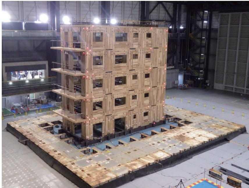
防災科学技術研究所の3次元振動台“E-ディフェンス”で実施された実大振動台実験。写真の5階建と3階建の試験建物に対して、阪神淡路大震災の観測波よりも大きな加力を入力し、変形量、破損部位を調べ、倒壊しないことを確認。
