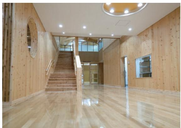
準耐火構造の燃えしろ設計により現しとしたCLT壁。くり抜くことも可能
