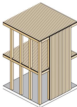
軸組工法+CLTパネル
