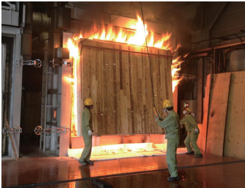
日本住宅・木材技術センターの耐火炉で実施された、CLT現し壁の準耐火構造加熱実験。木材が毎分約1mmの速度でゆっくり燃え進むことをを利用して、厚さ90mmのCLTが1時間で約60mm燃えた際にも壁が燃え抜けないことを確認。
