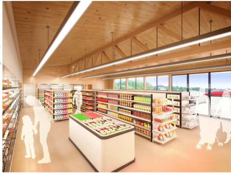
建物両端のコアゾーンに耐力壁を集めることで、中央の売場スペースには柱や壁を設けず、自由に棚を配置できます。必要に応じて鉄骨を組み合わせることで、より広い売場をつくることも可能です。
