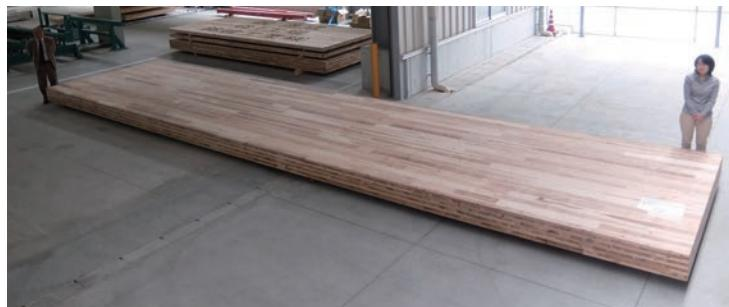
CLT (Cross Laminated Timber) とは、ひき板を繊維方向が直交するように積層接着した木質系材料です。欧米を中心にマンションや商業施設などの壁や床として使用され、大型建築物を木造で可能にする建築資材として、国内でも実績を増やしています。また、CLTは製造に地域材を活用することで地域振興、地方創生に貢献でき
