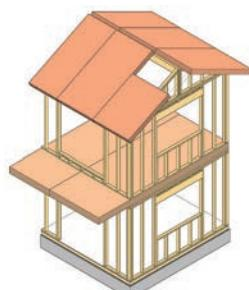
枠組壁工法+CLT
